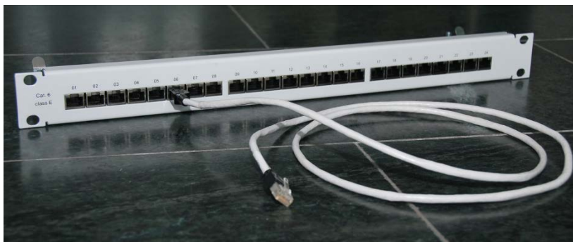
Abbildung 3 Kategorie 6 Verteilerfeld und Verteilerkabel mit RJ-45 Steckern
